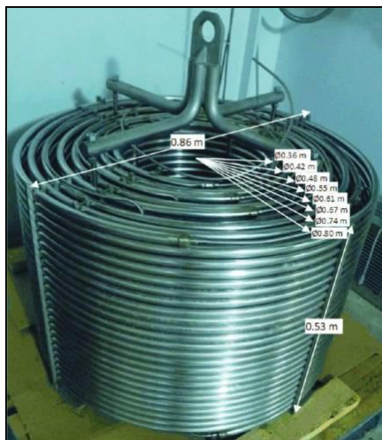
Рисунок 10 – Реактор непрерывного действия объемом 73 литра [54]
